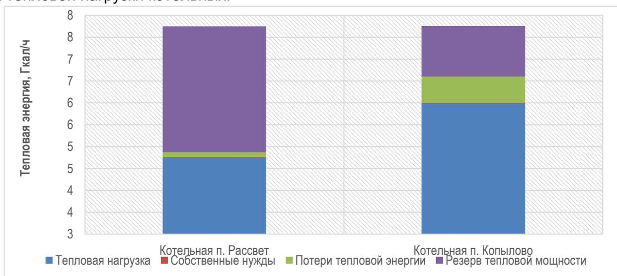
Рис. 1.17. Баланс тепловой мощности и тепловой нагрузки
