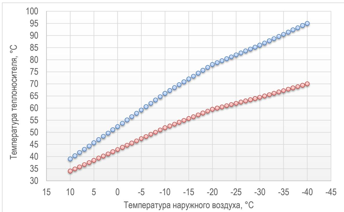
Рис. 1.4. Температурный график отпуска тепловой энергии п. Рассвет
