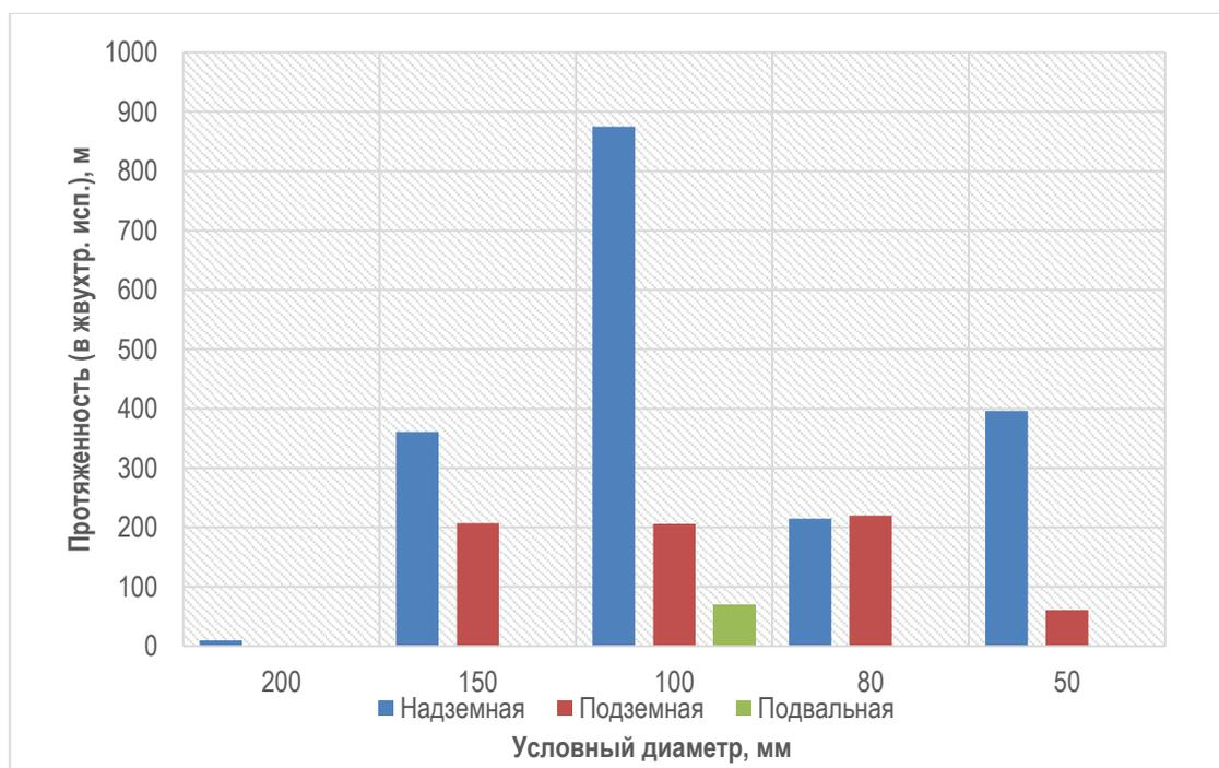
Рис. 1.8. Структура сетей отопления котельной п. Рассвет
