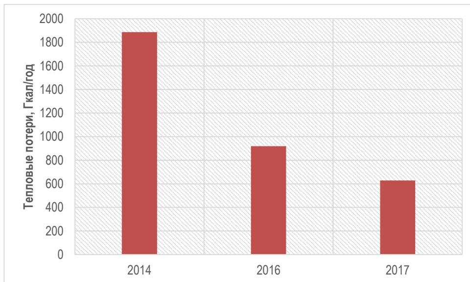
Рис. 1.12. Потери в тепловых сетях п. Рассвет
