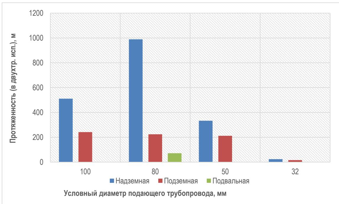
Рис. 1.9. Структура сетей ГВС котельной п. Рассвет
