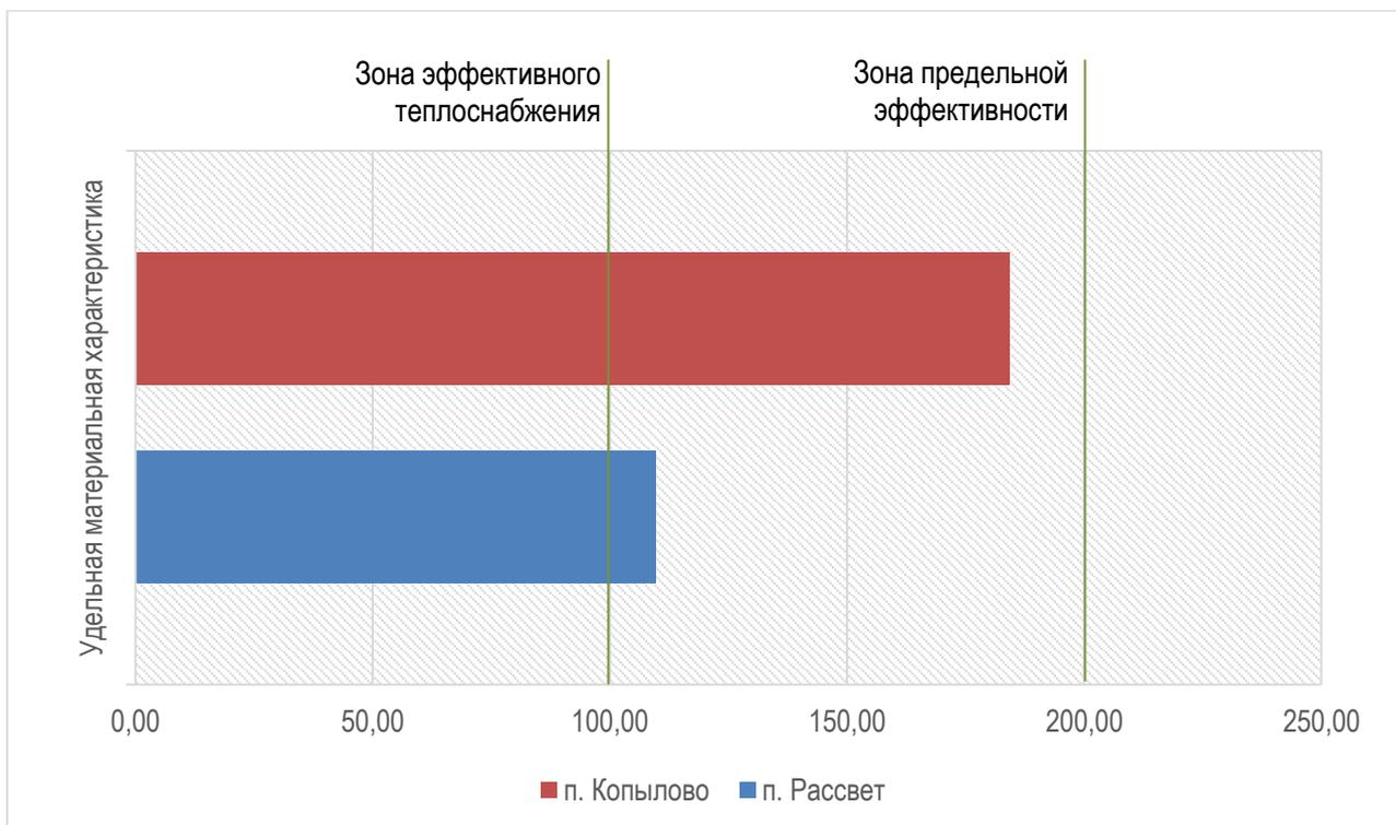
Рисунок 1.16 – Результаты расчета эффективности теплоснабжения (по удельной материальной характеристике)
