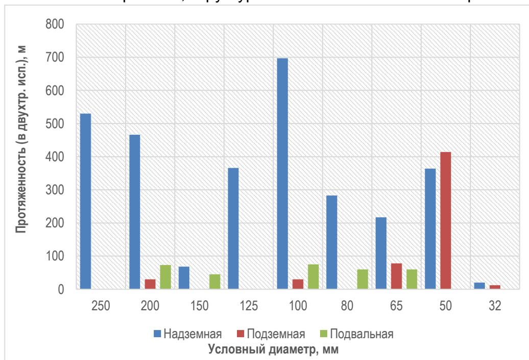
Рис. 1.6. Структура сетей отопления котельной п. Копылово
