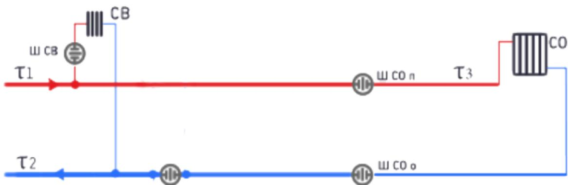
Рисунок 1.13 – Схема присоединения теплопотребляющих установок (система отопления) потребителей к тепловым сетям
