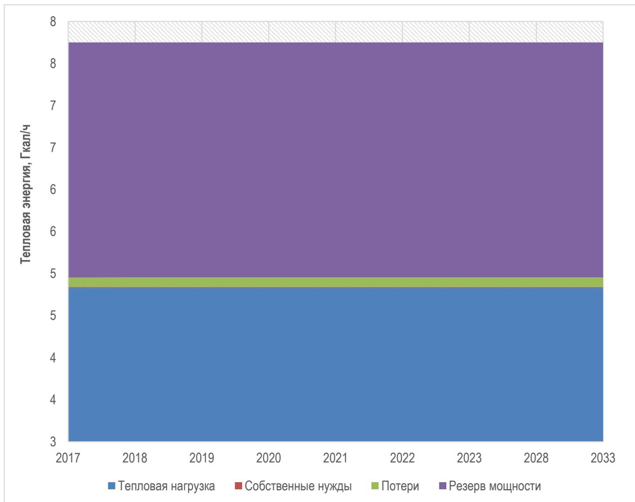
Рис. 4.2. Перспективный баланс тепловой мощности и присоединенной тепловой нагрузки котельной п. Рассвет
