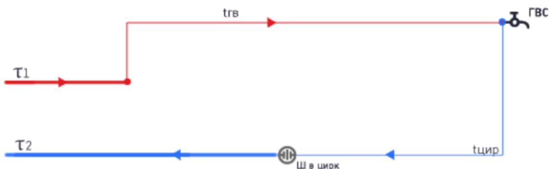
Рисунок 1.14 – Схема присоединений теплопотребляющих установок (система ГВС) потребителей к тепловым сетям
