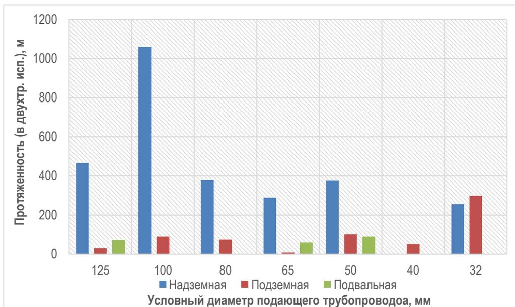
Рис. 1.7. Структура сетей ГВС котельной п. Копылово
